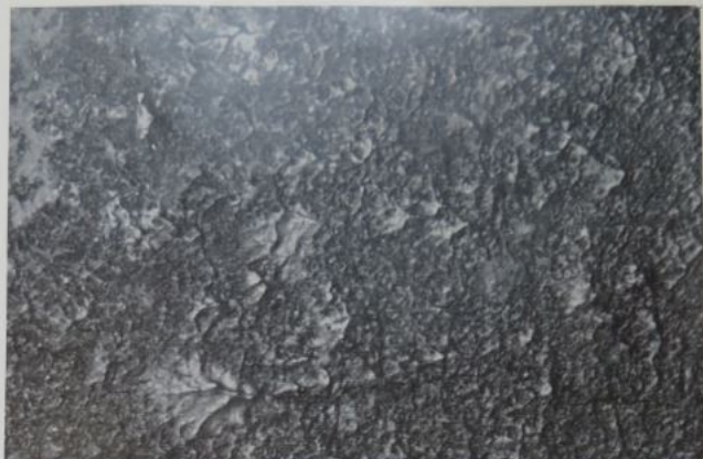
Abb. 5. In der Schmelzkruste der Seitenflächen erkennt man asymmetrische, dünenartige Aufragungen. Aus ihrer Verteilung läßt sich die Richtung größten Luftwiderstandes beim Fall (im Bild von links nach rechts) erschließen. — Vergr. etwa 10 \times ; alle Aufn. G. BIRKE.
